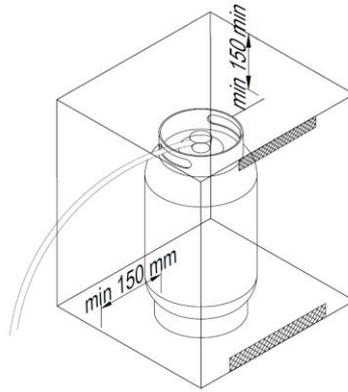
Fig. 4 – Boîtier pour bouteille de gaz
